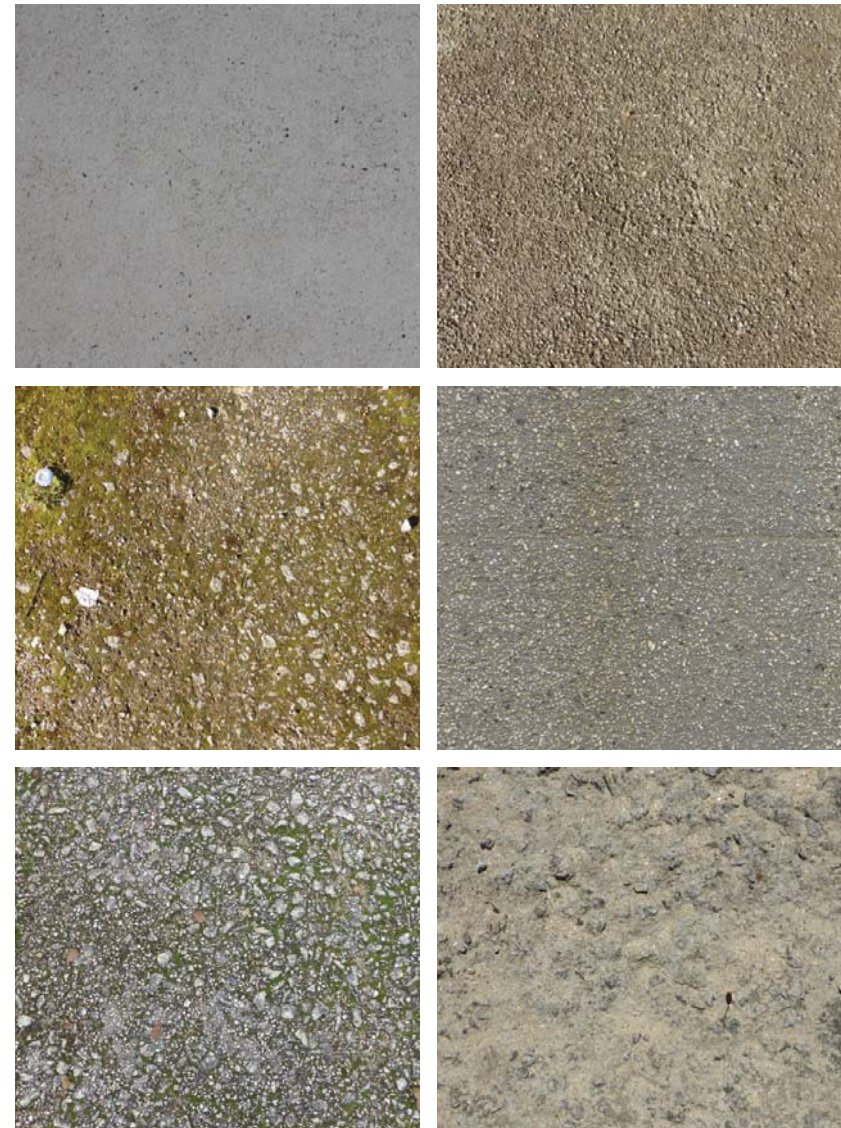
Figura 80. Texturas de pavimentos de formigón continuos
