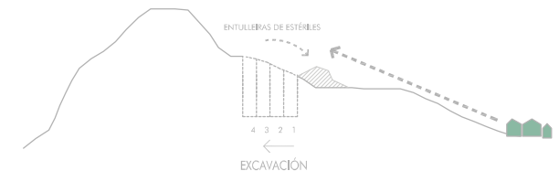
CANDO NON SEXA POSIBLE REALIZAR MINERÍA DE TRANSFERENCIA INICIAR A EXCAVACIÓN NO PUNTO MAIS BAIXO
