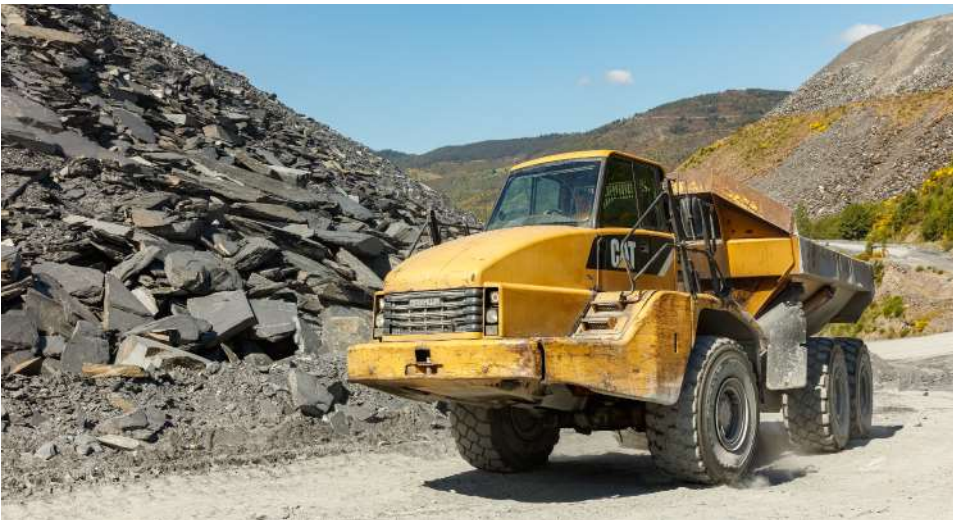
Imaxe 34. Transporte de estéril a entulleira. Fonte: UVigo
