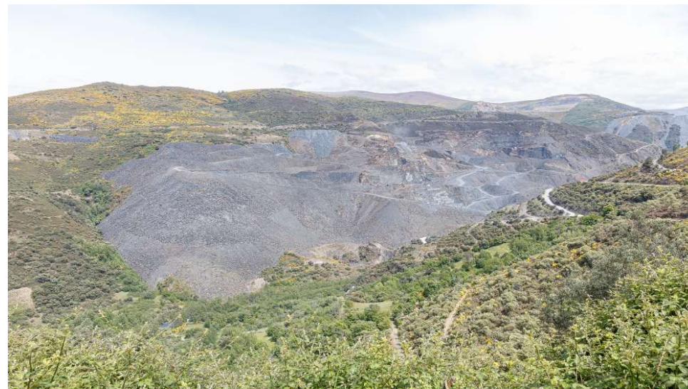
Imaxe 10. Explotacións de lousa, apréciase a alteración da topografía polas entulleiras xeradas. Fonte: UVigo
